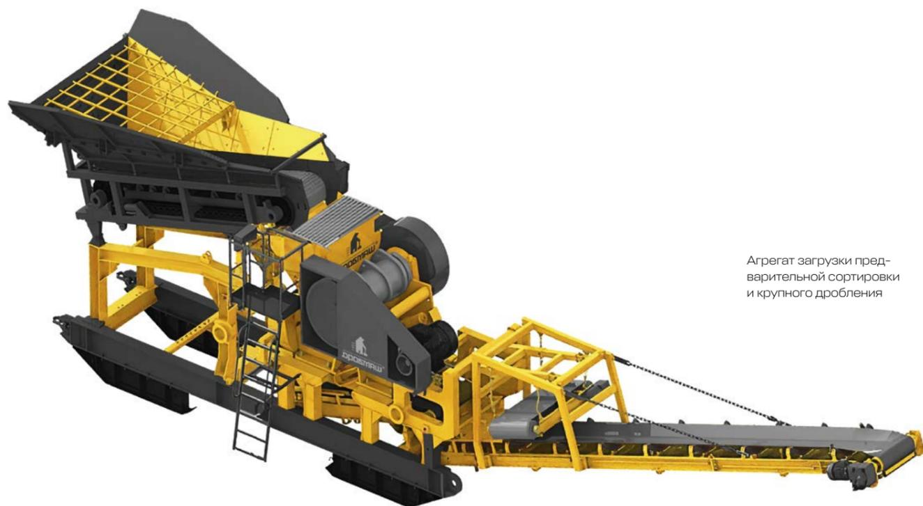
Агрегат загрузки предварительной сортировки и крупного дробления
