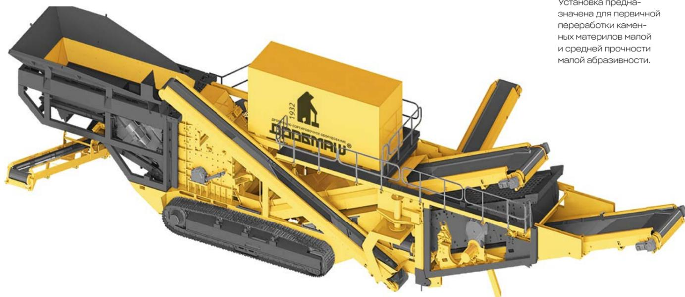
Установка предназначена для первичной переработки каменных материалов малой и средней прочности малой абразивности.
