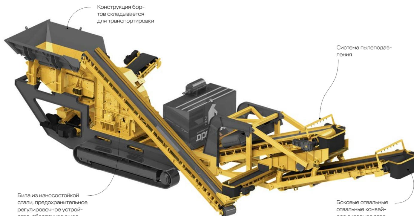
Конструкция бортов складывается для транспортировки
